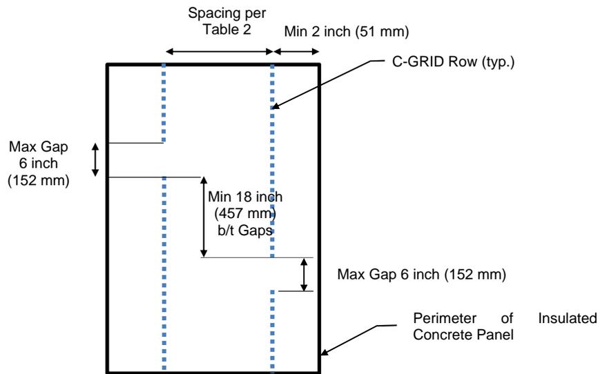
FIGURE 2—C-GRID PLACEMENT
